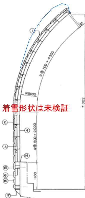
そのような箇所においては雪止め装置設置の後付けを余儀なくされているところ(雪止め装置には懸案が内在する)
