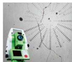
現在の技術(ひび割れ計測システム) ひび割れ被覆工法(ケイ酸塩系)
