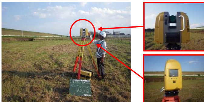
レーザースキャナによる現況測定
