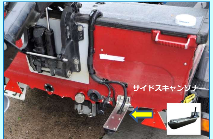
図 サイドスキャンソナー（調査船の船尾に装備）
