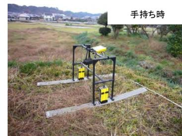
地中レーダ装置 (Sensors & Software社製: pulse EKKO Pro)
