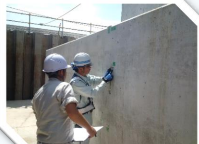
コンクリート構造物表面評価法体験
