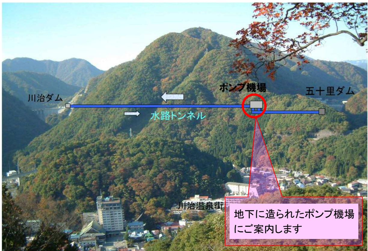
五十里ダムは、流域面積が大きい割には、貯水容量が小さいダムです。連携施設は、水の有効利用のために、五十里ダムに貯めきれない水を川治ダムに送り貯め置くことができる、水のネットワーク施設です。
