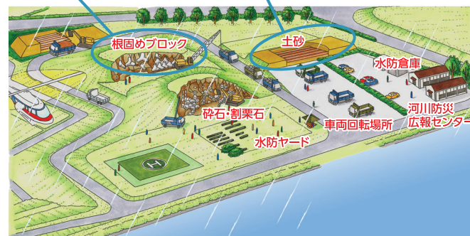
●災害復旧に欠かせない資材が備蓄されている河川防災ステーション
