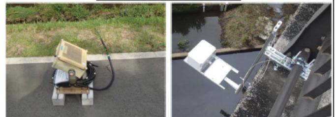
堤防に設置するタイプ(ケーブル(計測器)を河川に入れて計測)      橋梁に設置するタイプ(電波や超音波で河川に触れずに計測)
