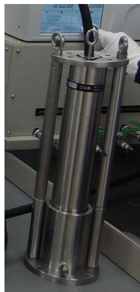
簡易水位計 設置状況 水晶式センサー
