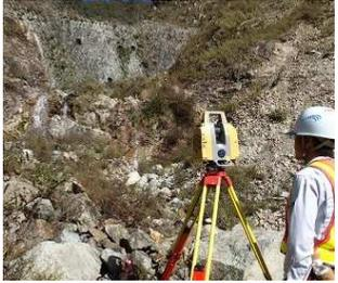
人の立入が危険な急傾斜も短時間で面的に3次元測量を実施
