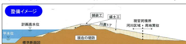
図-1 7H堤防整備断面
