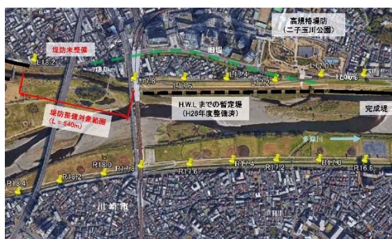
図-1 二子玉川地区の堤防整備状況
