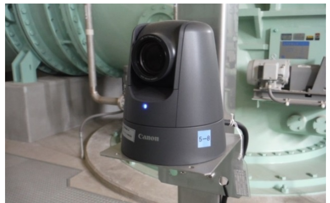
図-6 ネットワークカメラ（パン・チルト方式）
