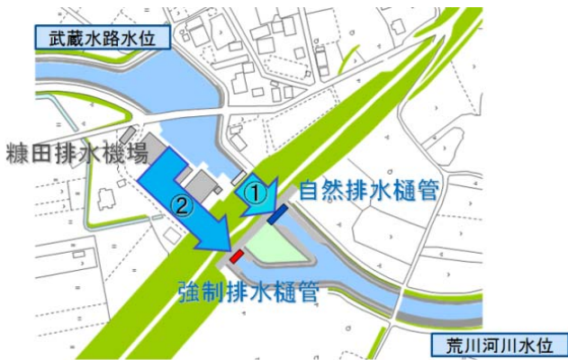
図-2 糠田排水機場の運転条件
