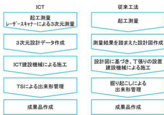
図-4 舗装工事の流れ
