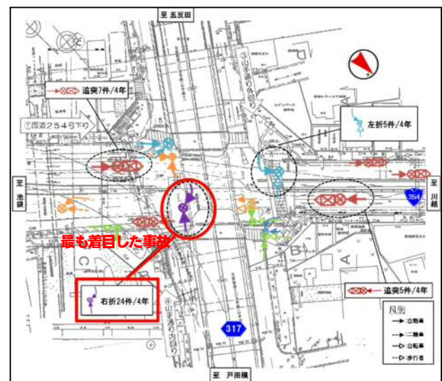
図-7 熊野町交差点における事故発生状況 (主たる事故)
