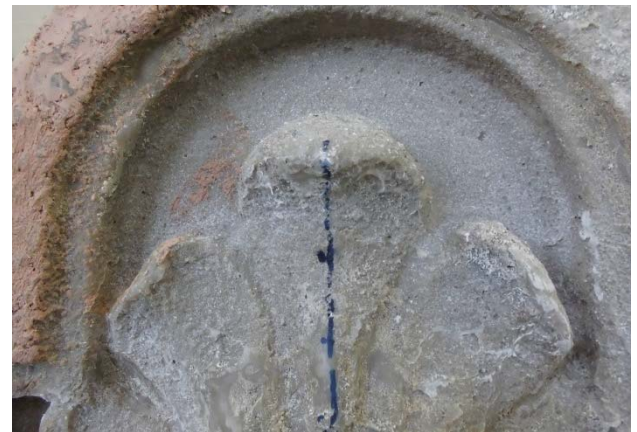
写真-7 既存から型どりしたプラスチックモデル
