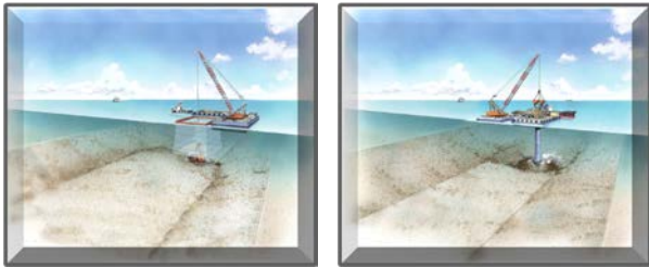
図-2 床掘・基礎マウンド設置
