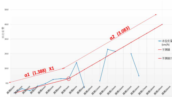
図-4 降雨量毎の水位変化量と水位変量係数(4.3 m 3 /s)
