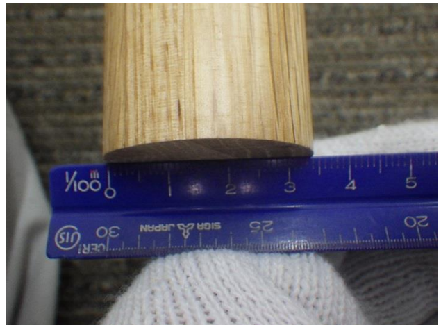
写真5 黒板と一緒に写っていない工事写真 (材料検収)
