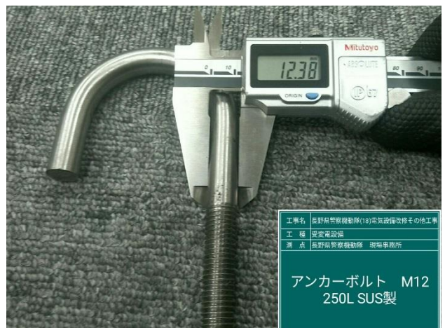
写真6 電子小黒板と一緒に写っている工事写真 (材料検収)
