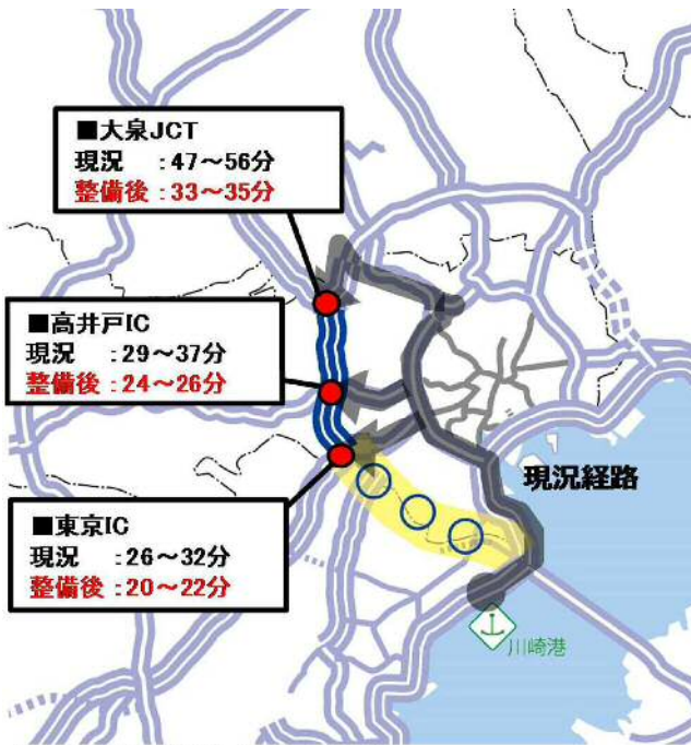
※所要時間は、ETC2.0(H28.4~6データ)を用いて算出 (平均値と90%タイル値を表記) ※外環(東名~湾岸、関越~東名)は、外環(関越~東名)の設計速度80km/hと設定 ※図面上の道路ネットワークは、平成28年度末時点 図-2 所要時間の短縮効果(川崎港の事例)
