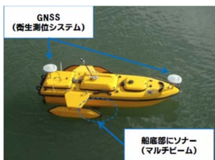
写真-1 小型無人ボートによるマルチビーム測量機器
