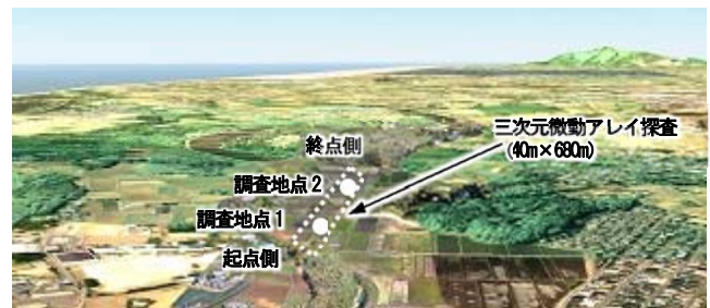
図-1 三次元微動アレイ探査箇所の点群データ
