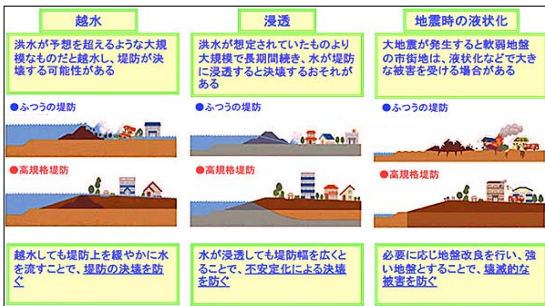
図-1 「ふつうの堤防」と「高規格堤防」の違い（荒川下流河川事務所 HP）
