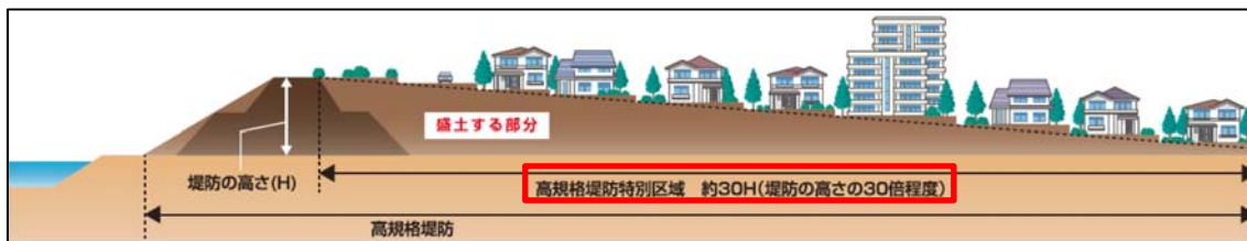
図-2 高規格堤防の整備イメージ (荒川下流河川事務所 HP)
