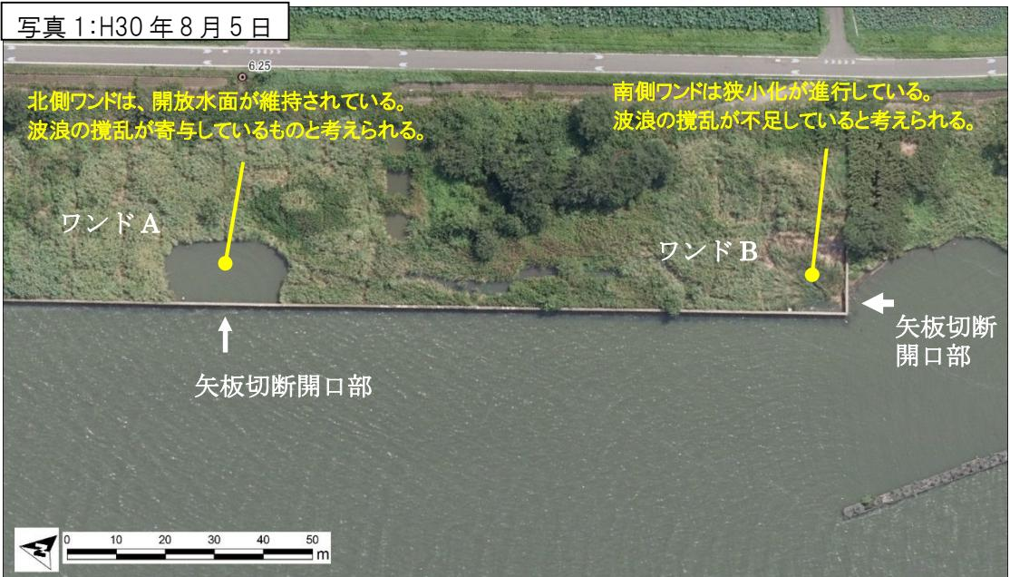
図 A区間のワンドの航空写真と既往の矢板切斷開口部の位置（切斷開口前）
