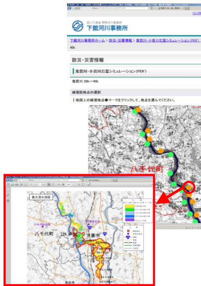
決壊地点毎に想定した時系列の氾濫シミュレーション
