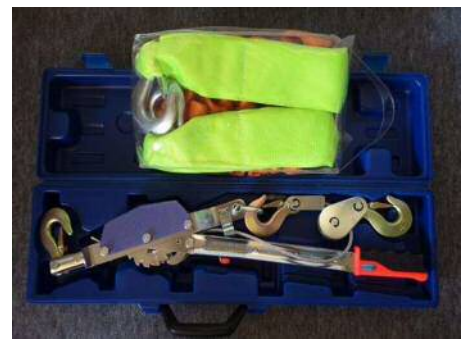
◎牽引用ハンドウィンチ(大宮国道)
