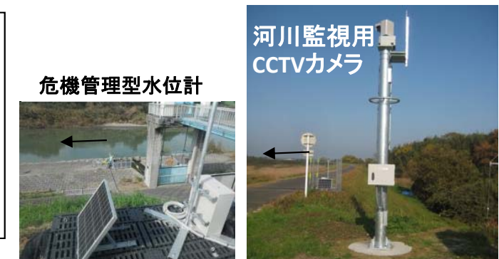
河川監視用CCTVカメラや危機管理型水位計による観測
