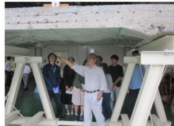
実際に使われていた橋梁断面の損傷を見ながら打音の違いを確認
