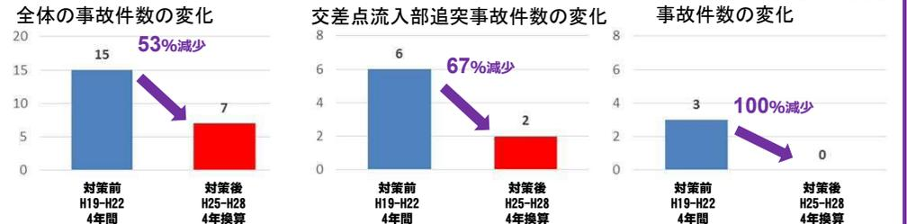
流入部追突事故、上り線流出部沿道出入関連事故ともに減少しており効果が確認できる。舗装の痛みやカラー舗装のすり減りが見受けられるので、舗装打ち変えにあわせてカラー舗装や路面表示の補修を実施し事故対策効果を継続的に発現させていく。 ※ボアソン判定非該当
