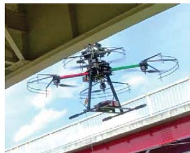
▲橋梁の損傷写真を撮影する技術
