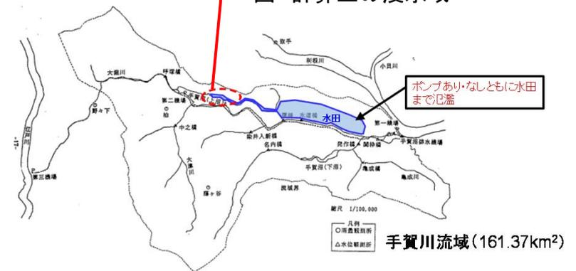
図 第一機場ポンプの有無による流出ボリュームより算出した浸水被害の変化(H25年 台風26号)
