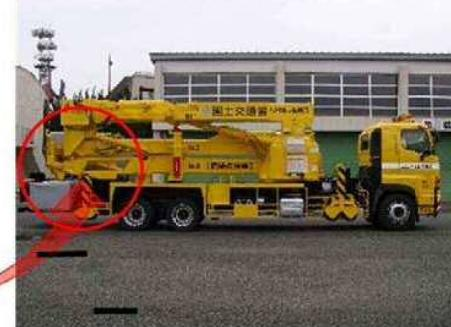
既存の橋梁点検車のバスケットに上下伸縮式作業台(アタッチメント)の取付けができるよう開発
