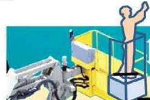
現地にてバスケットに軽量な上下伸縮式の作業台を取付ける。
