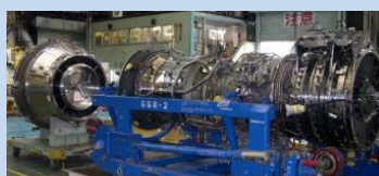
排水ポンプのガスタービンエンジン
