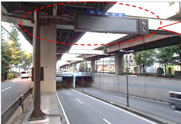
①アンダー手前に冠水情報を提供する電光標示板設置
