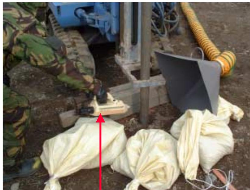
検知器によるガス検知
