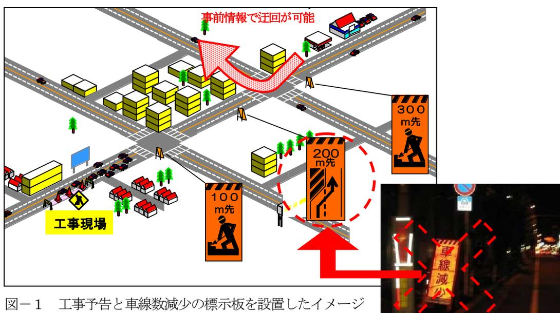
図-1 工事予告と車線数減少の標示板を設置したイメージ
