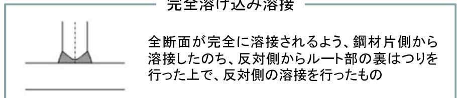
完全溶け込み溶接
