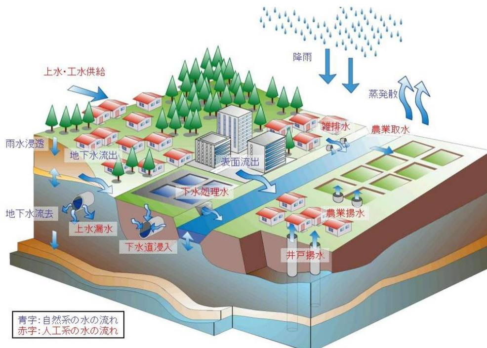
図 水循環解析モデルの概念図
