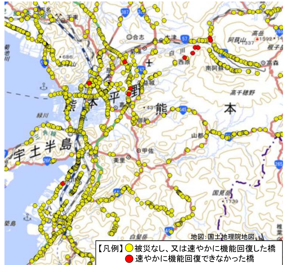
図-1 緊急輸送道路の橋の耐震性能の発揮状況 (熊本県内で震度6弱以上を観測した主な地域)
