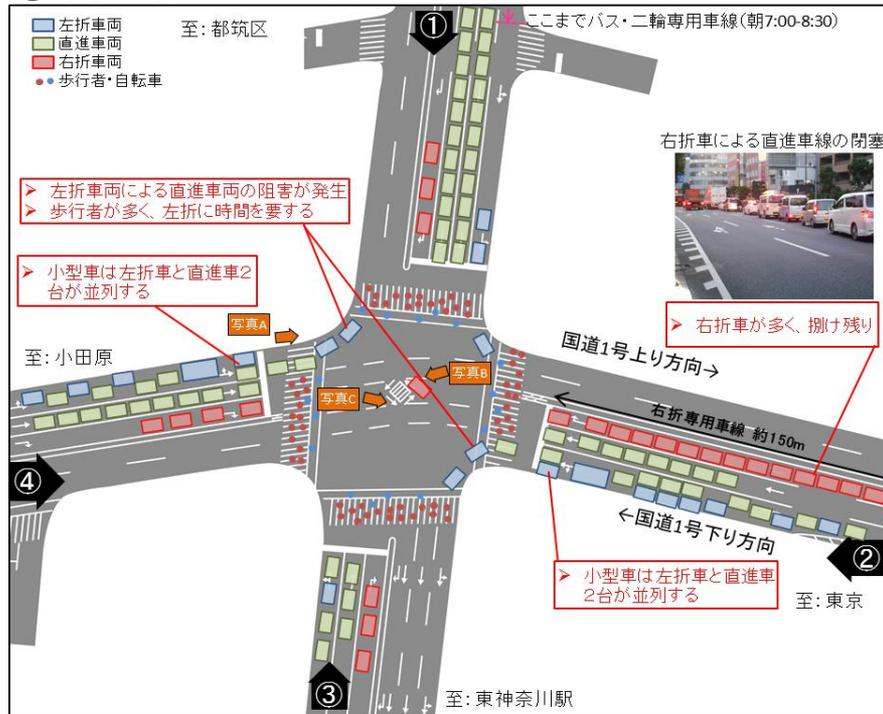
写真A 【国道1号(上り方向)歩行者が多く左折に時間を要する】
