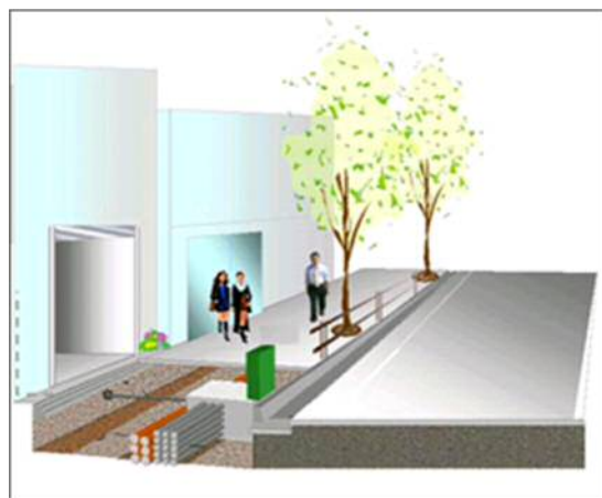
電線共同溝整備イメージ図
