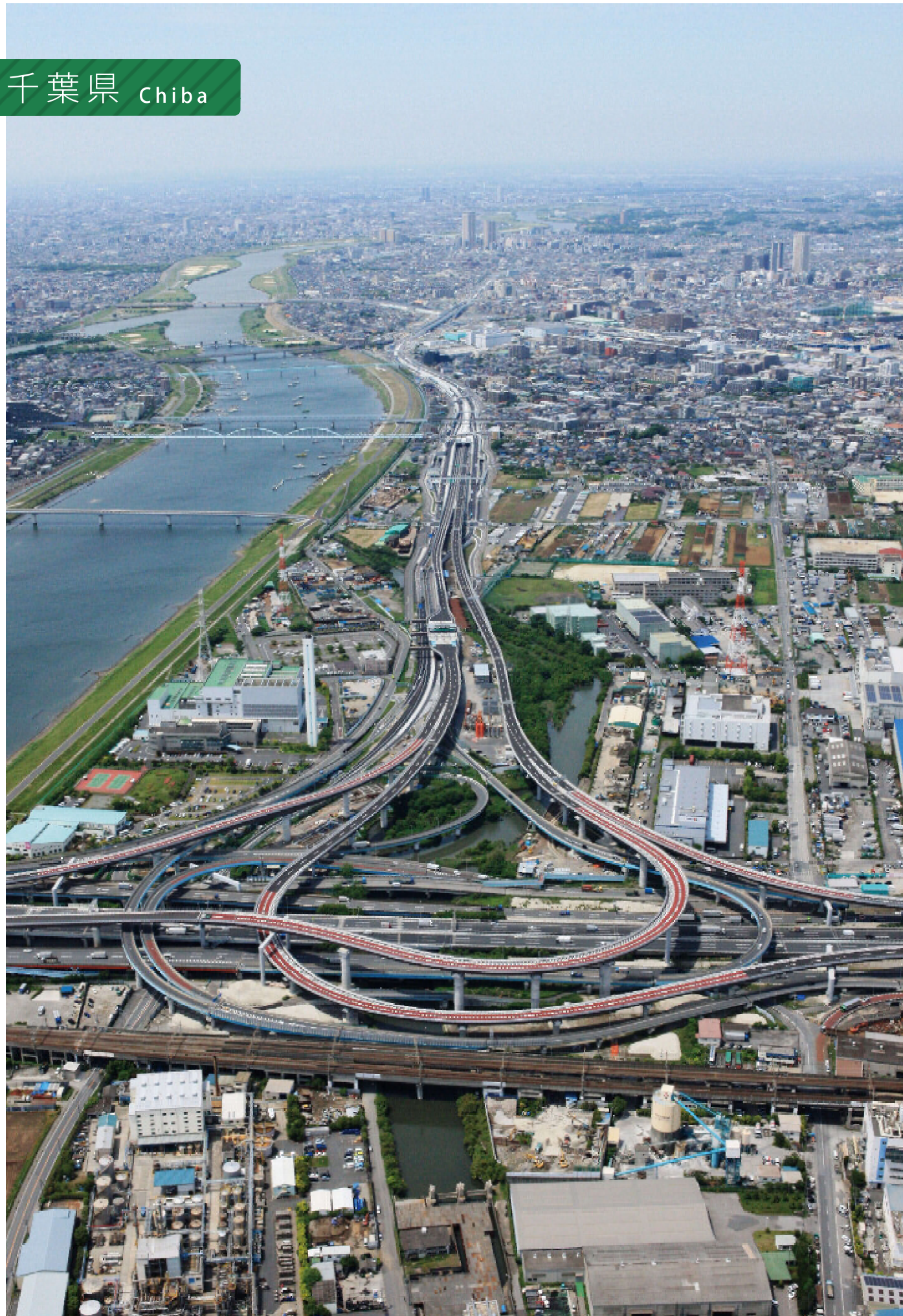
高速道路同士・国道同士を同一箇所接続する高谷JCT ([C3]外環道—[E51]東関東道・首都高速[B]湾岸線、国道298号—国道357号) 平成30年5月11日撮影
