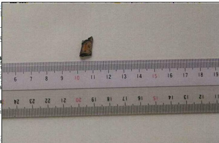
落下した腐食金属片
