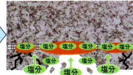
錆の膨張がさらに進行すると、やがてコンクリート本体が破壊され、破片の落下や橋の強度低下を引き起こします。また、破損箇所から塩分が侵入しやすくなり、新たな錆が発生します。
