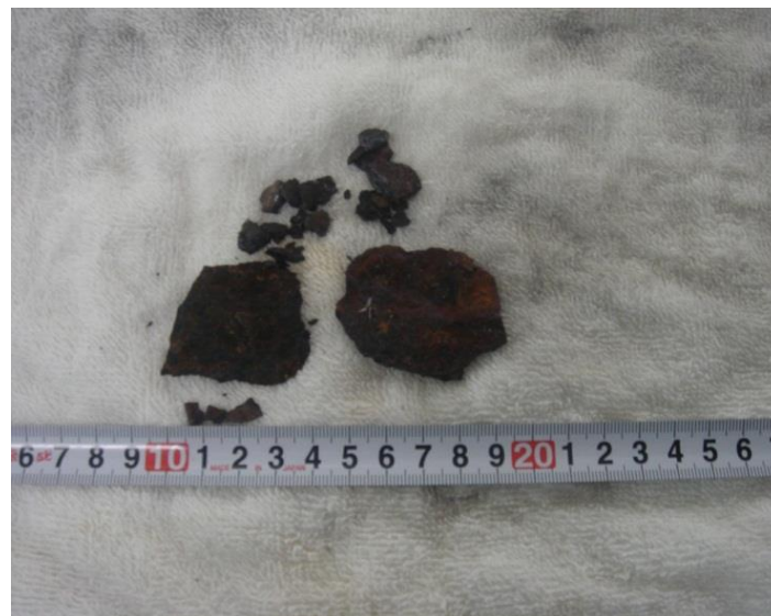
落下した腐食金属片（一部）
