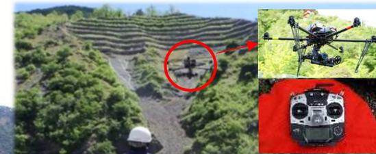
UAV(ドローン)による測量
