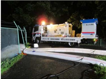
排水ポンプ車は、機動性を生かして迅速かつ確実に目的地(出水箇所)へ移動し排水作業を遂行することを目的とした災害対策用機械です。
