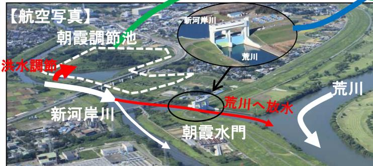
洪水時に朝霞水門を開けて荒川に放水。さらに、朝霞調節池に洪水を流入させ、新河岸川の水位を低減。
