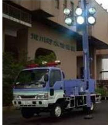
照明車は、夜間作業時に災害現場を明るく照らし、災害復旧などを安全に行えるようにするほか、避難所などの照明として設置することもできます。
