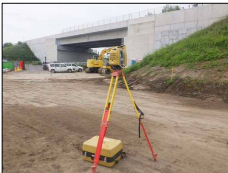
LS3次元起工測量 (新技術：地上型3次元レーザスキャナによる形状計測)
