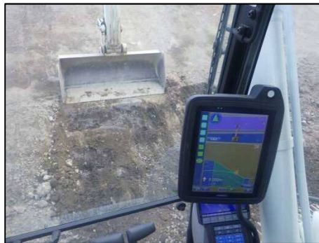
GNSSによるバケット位置情報と3次元設計データの運動状況 (コントロールパッド表示)
