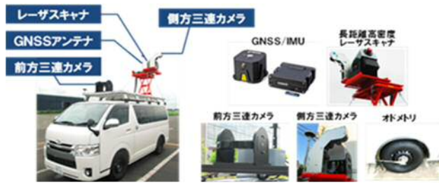
図-2 MMSによる計測イメージ
