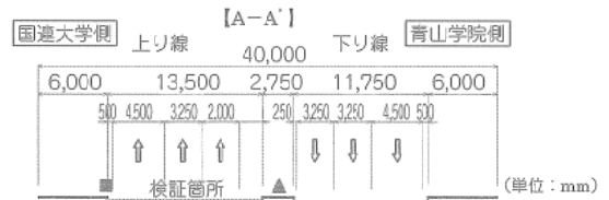
図-5 試験施工箇所の標準断面図 1)
